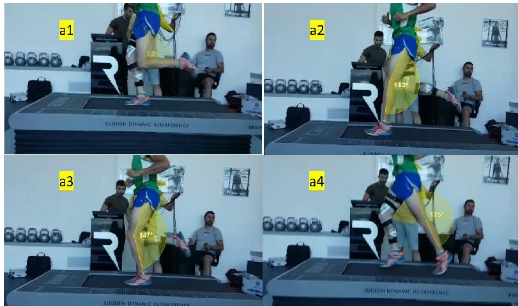
Fig. 4.5b descrizione cinematica delle varie fasi che compongono un passo di corsa
