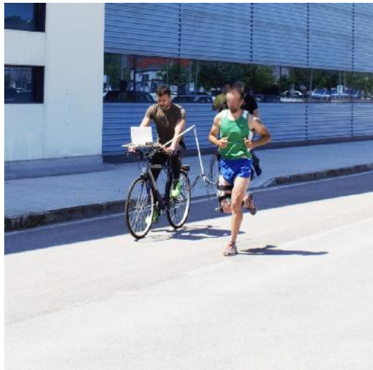
Fig. 4.6 bici preparata per la prova con sistema di fissaggio cavi
