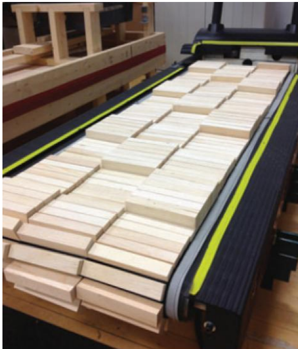
Fig. 3.5 tapis roulant modificato per ottenere una superficie irregolare
